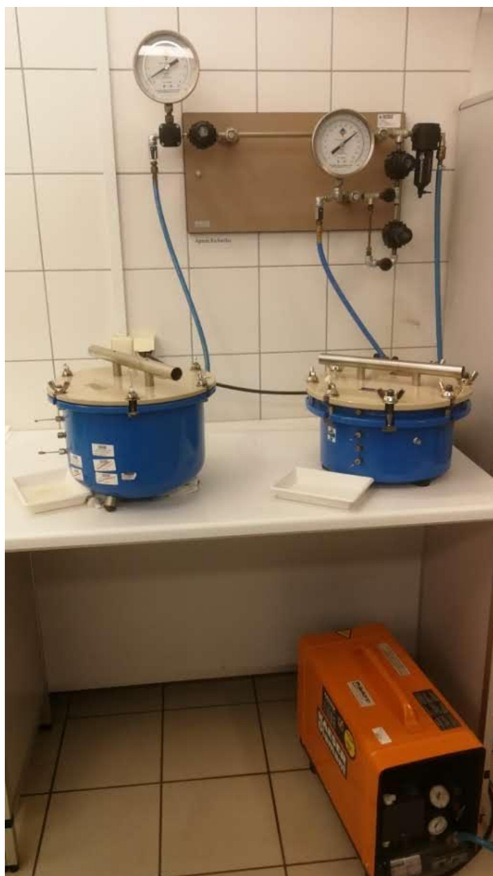
Zdjęcie 41. Aparatura wykorzystywana do oceny właściwości wodno-powietrznych gleb
