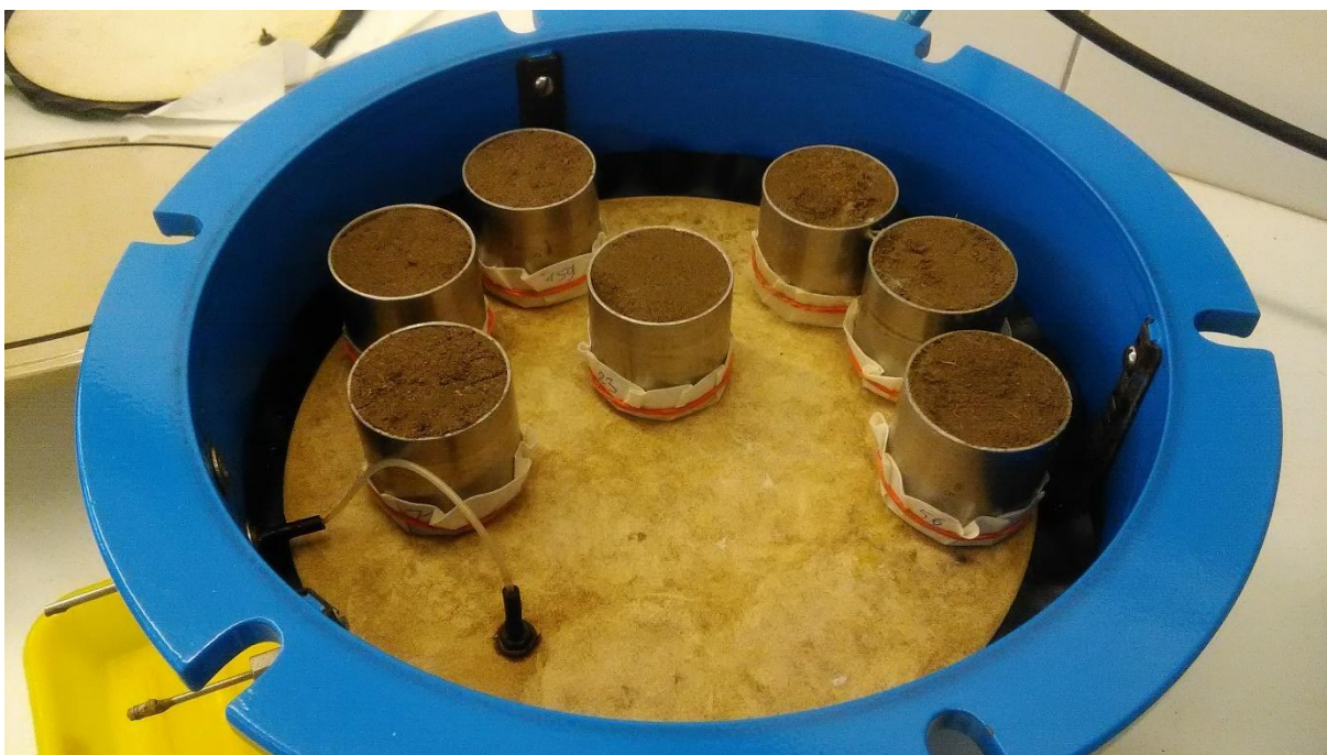
Zdjęcie 42. Próbkę gleby w trakcie przygotowania do analizy właściwości wodno-powietrznych gleb
