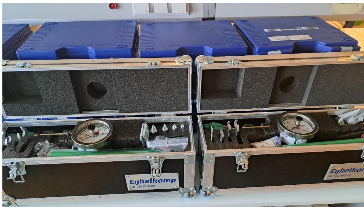
Zdjęcie 32. Penetrometry zakupione w ramach projektu umożliwiły sprawny pomiar zwięzłości gleby w wielu punktach doświadczeń polowych.
