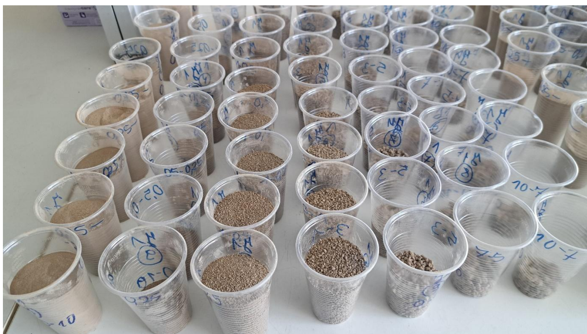
Zdjęcie 35. Analiza składu agregatowego gleb metodą przesiewania na sucho
